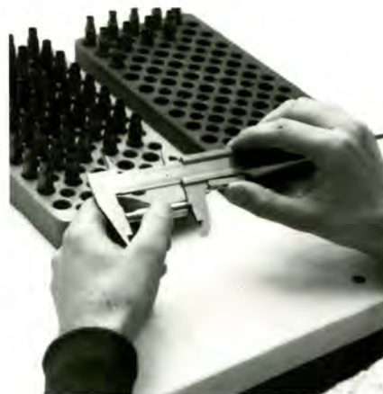
Mit der Schieblehre wird die Hülsenlänge kontrolliert.
