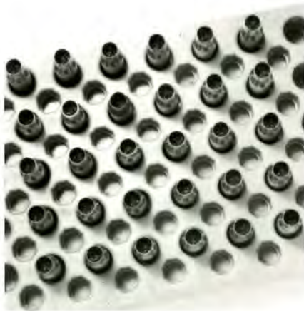
Visuelle Kontrolle der richtigen Füllhöhe.
