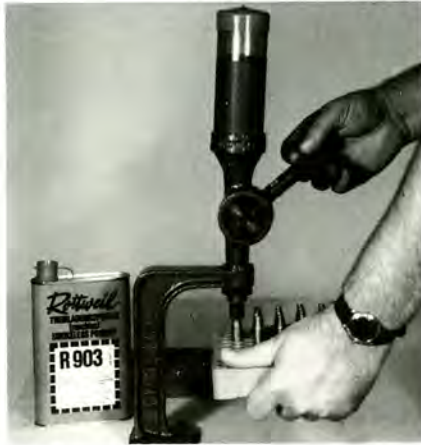
Pulverbefüllung mit Dosiergerät.
