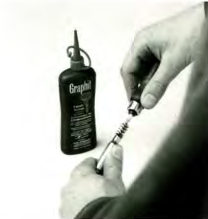
Trockenschmierung des Hülsenmundes.
