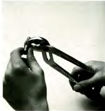
Fehlerhafte Hülse unbrauchbar machen.
