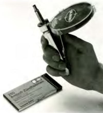
Zündhütchen setzen mit Handgerät.
