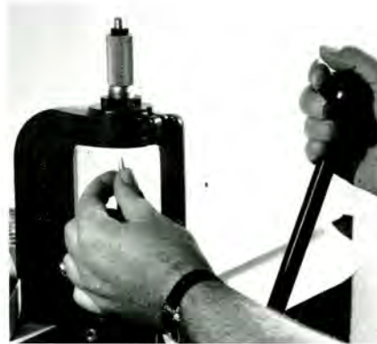
Geschloßsetzen mit Presse.
